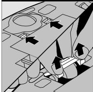
1. Обеими руками нажмите фиксатор переднего колеса и поднимите его вверх.
