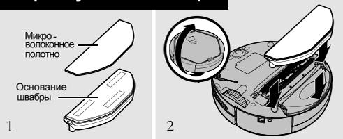
1. Переверните робота и установите основание швабры в соответствующие гнезда на корпусе робота.
