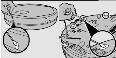
1. Протрите датчики на переднем бампере робота-пылесоса с помощью ватных палочек.
