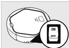
1. Если Вы не планируете использовать робота в течение длительного времени, выключите его, передвинув переключатель питания в боковой части робота в положение OFF.
