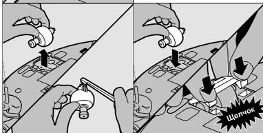
3. Извлеките переднее колесо и удалите пыль, грязь и посторонние предметы с помощью щётки для чистки. Снимите подшипники для облегчения очистки оси колеса.
