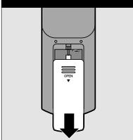
В комплектации поставки батареек не установлены в пульт ДУ. Перед использованием установите в пульт две прилагаемые батарейки, тип ААА.
