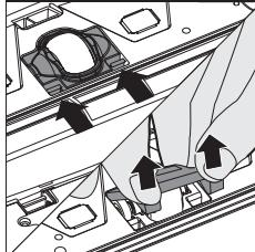
1. Нажмите фиксаторы колпака переднего колеса, а затем снимите колпак.
