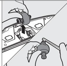
2. Очистите переднее колесо с помощью прилагаемой щетки или ватных палочек.
