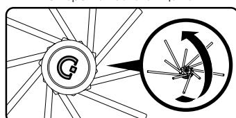
! Для установки боковых щеток используйте метки на корпусе робота-пылесоса и щетках.
