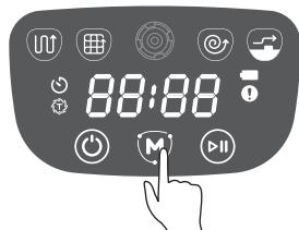
Режим «CLIMB» – преодоления порогов включен по умолчанию (робот преодолевает дверные пороги высотой до 15 мм). Отключение данного режима предотвращает переход робота через пороги и заезд на ковер или коврик высотой выше 5 мм.
